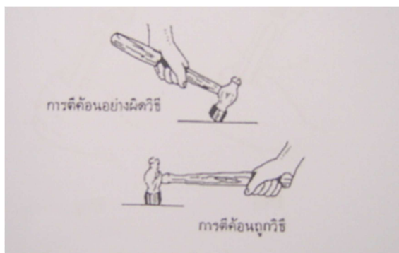
รูปที่ 7.6.7-2 การจับค้อนและหน้าสัมผัสค้อน
